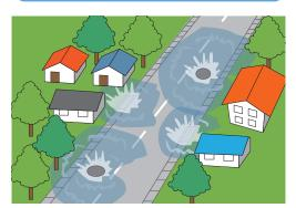
排水路・側溝の排水能力を超え る豪雨によって、土地・建物等の浸 水が発生する現象(内水はん濫)が 頻発しています。
